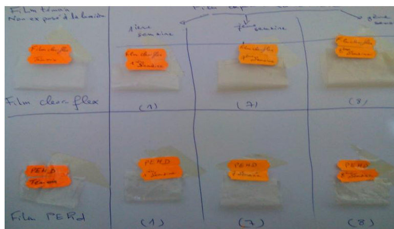
Figure 5.10 : Jaunissement du film clearflex et PEhd après exposition à la lumière du jour.
