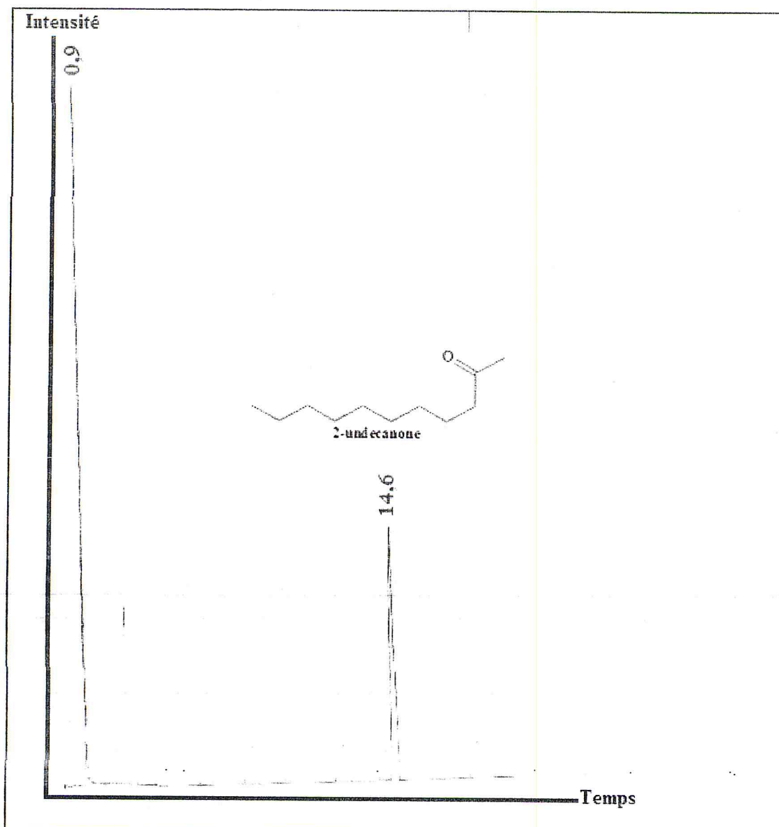
Figure 19: Chromatogramme d'huile essentielle de la rue de montagne extraite par Hydrodistillation assistée par Micro-onde
