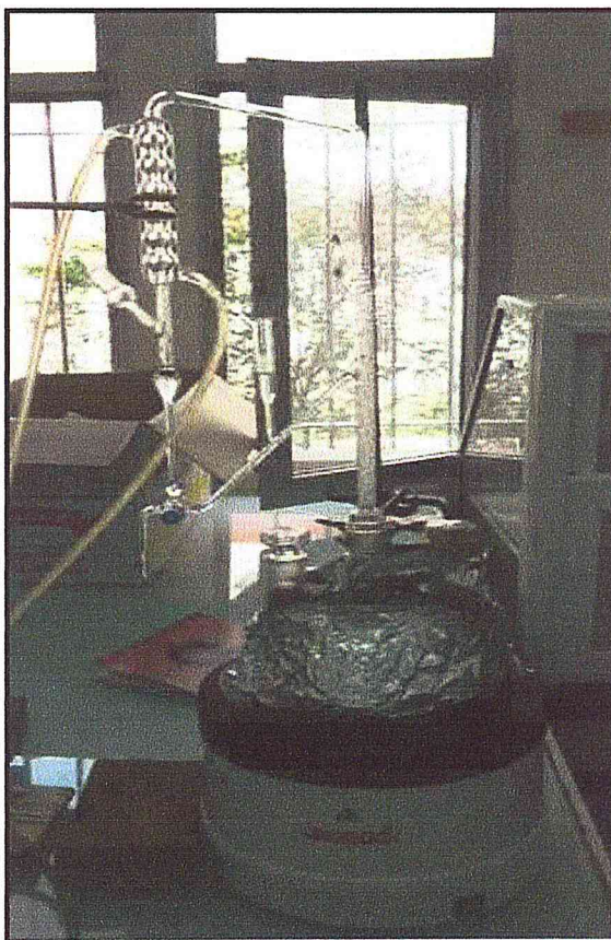
Figure 10 : Montage expérimental de l'extraction par hydrodistillation
