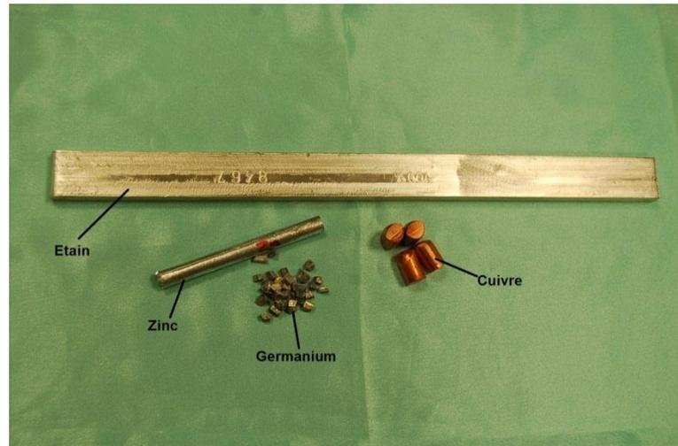
Figure 2.1 : Métaux de grande pureté utilisés pour la synthèse des échantillons.
