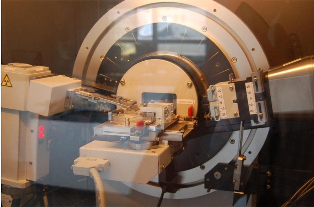
Figure 2.12 : Photographie d'un diffractomètre Bruker D8 *Advance*.
