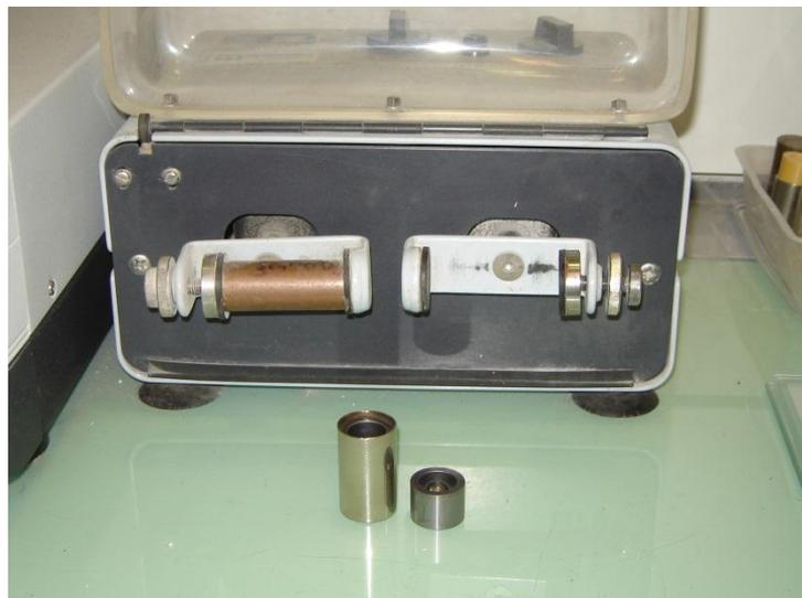
Figure 2.13 : Broyeur à bille
