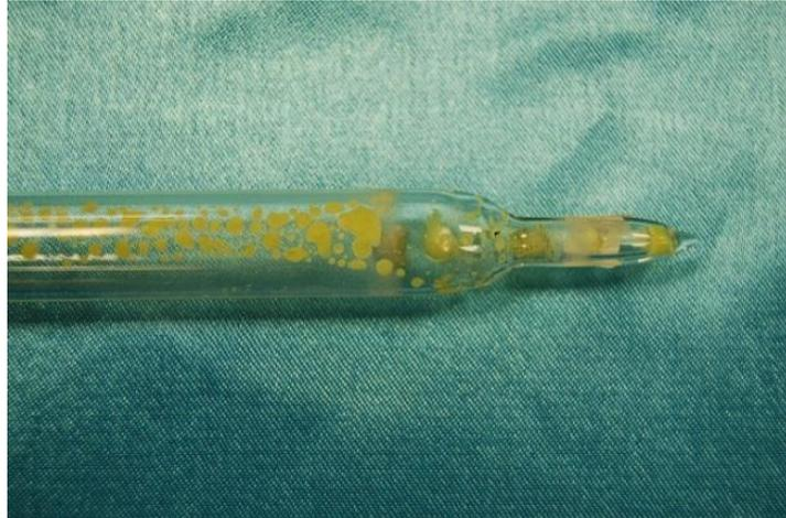
Figure 3.3 : Ampoule après synthèse de l'échantillon E8 (12% d'excès de soufre).
