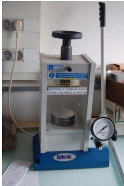
Figure 2.4 : Presse hydraulique utilisée pour le compactage des mélanges.
