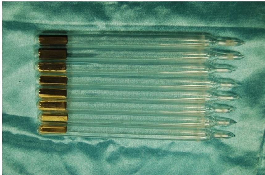
Figure 2.5 : Ampoules scellés sous vide contenant des échantillons CZTS
