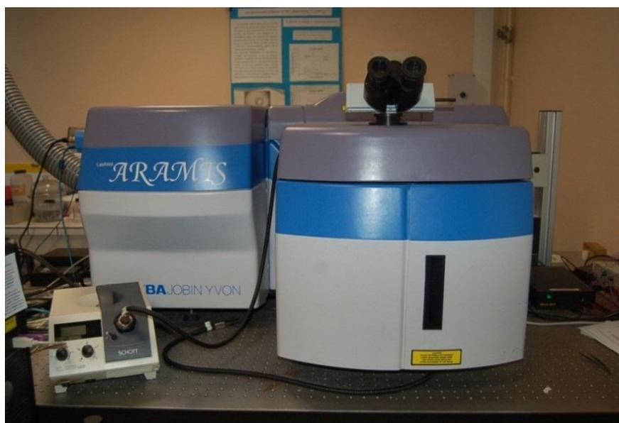
Figure 2.16 : Microspectromètre Jobin-Yvon ARAMIS.
