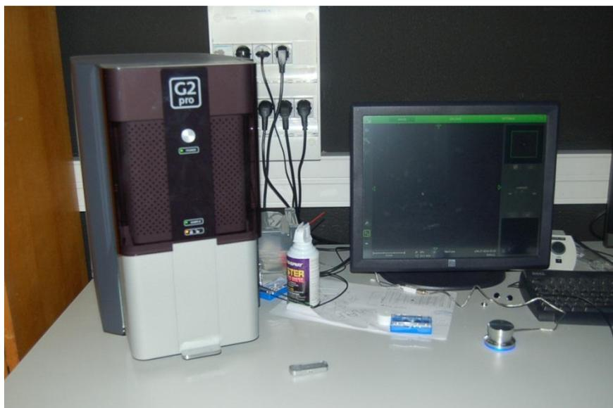
Figure 2.18 : Microscope électronique à balayage G2pro.
