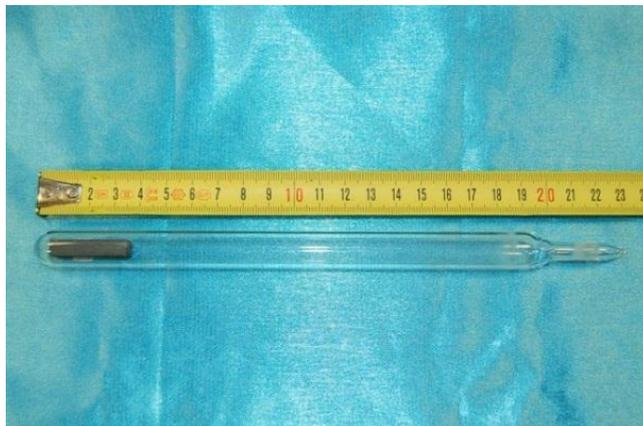
Figure 3.1 : Ampoule en quartz scellée sous vide contenant une charge CZTS
