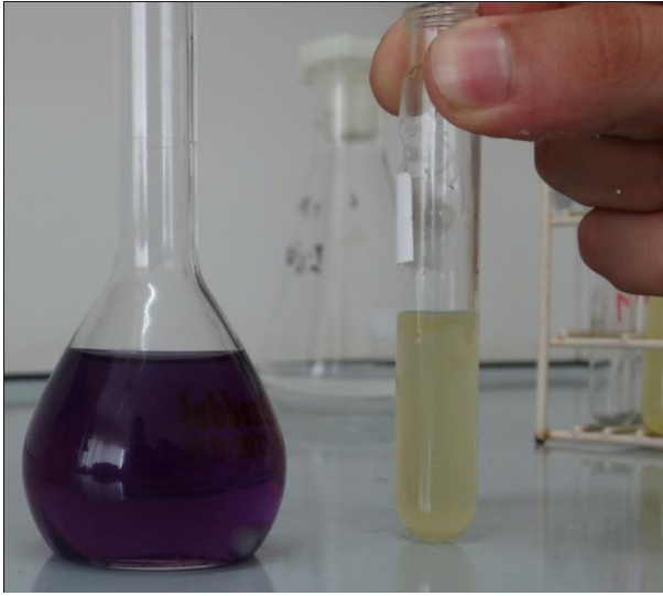
Figure 15: Virage de la couleur du DPPH en solution avec la vitamine C
