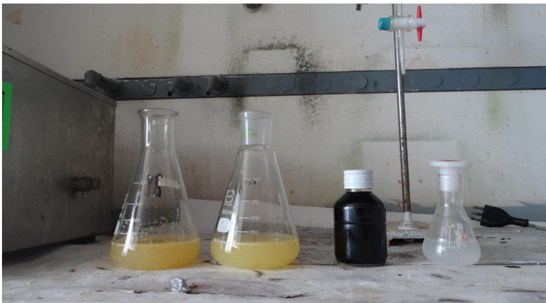
Figure 12: Dosage de la vitamine C par titrage " Boisson, Iode 1N, Amidon"
