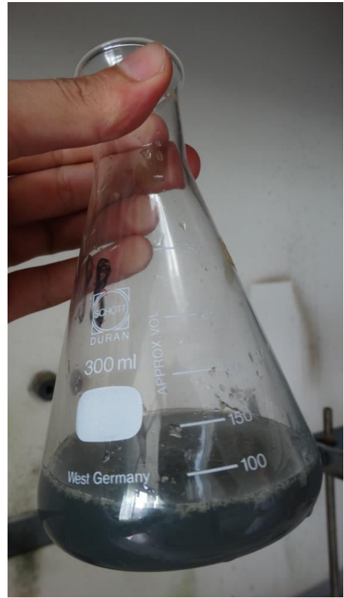
Figure 13: Virage de la couleur de solution lors du dosage de la vitamine C par titrage colorimétrique.
