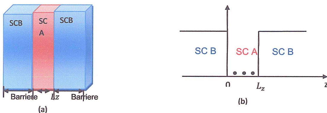
Figure 1.9 : Schéma synoptique (a) disposition des couches semi conducteurs A et B (b) barrière de potentiel créée entre les semi conducteurs A et B [29].
