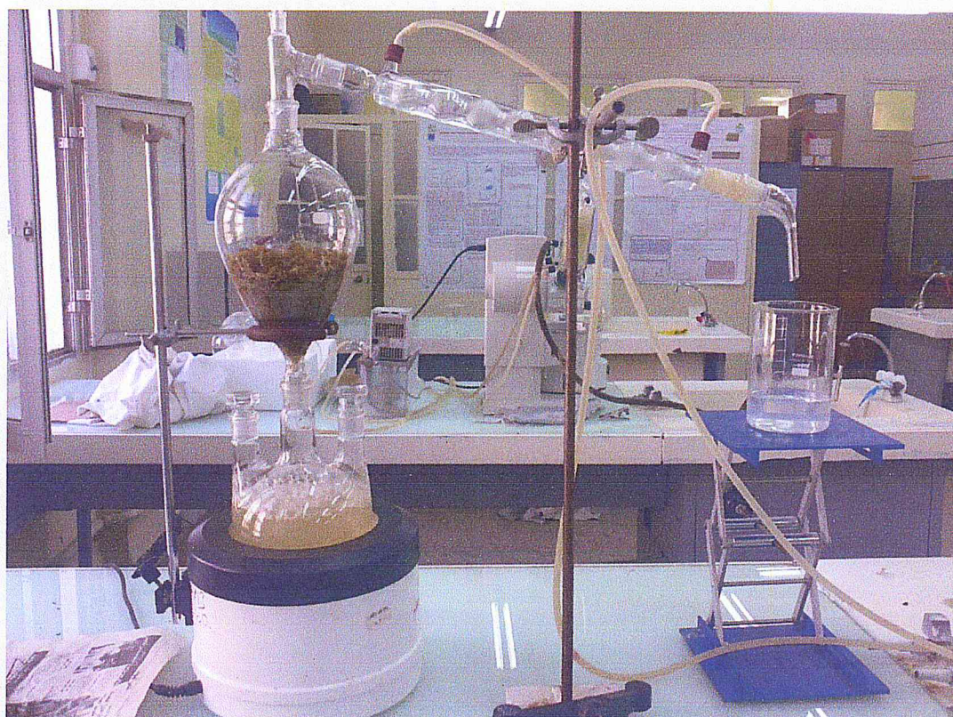
Figure 6 : Dispositif expérimental d'entraînement à la vapeur d'eau de l'HE.
