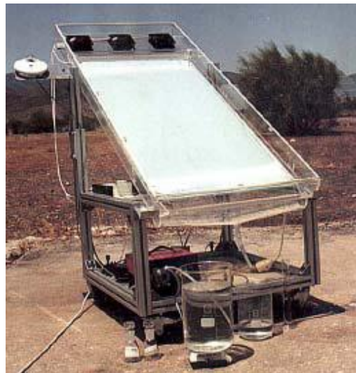
Figure II-8: Photoréacteur à lit fixe et à flux ruisselant ou Thin Film Fixed Bed Reactor (TFFBR) [132].
