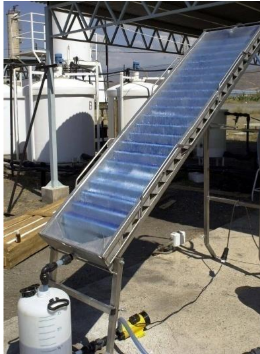
Figure II-7: Collecteur à non-concentration de type cascade testé à la PSA [132].
