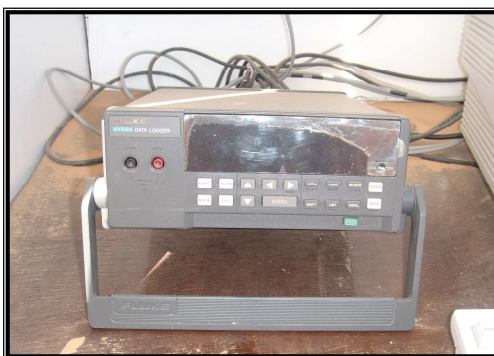
Figure 4.13 Appareil d'enregistrement digital type FLUKE à 20 voies
