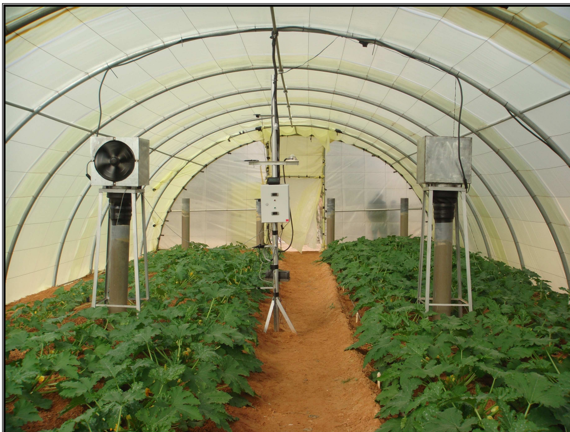
Figure 4.31 Vue interne de la serre expérimentale ayant le dispositif de stockage
