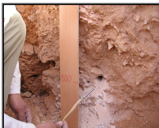
Figure 4.21 Disposition de la sonde PT100 dans le sol à 1m de profondeur
