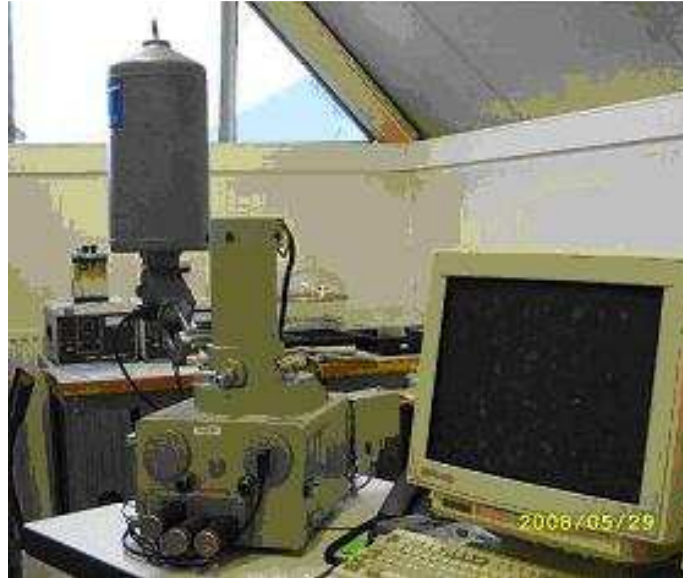
Figure 2.8: Appareil microscope électronique à balayage MEB.
