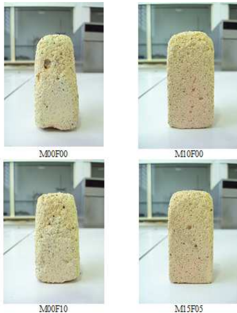
Figure 3.22: Photos des éprouvettes en mortier après 32 semaines d'immersion dans une solution de 1% HCl.
