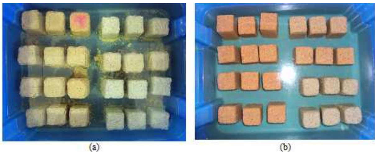
Figure 2.11: Immersion des éprouvettes dans les solutions acides a) 3% H 2 SO 4 et b) 1% HCl.
