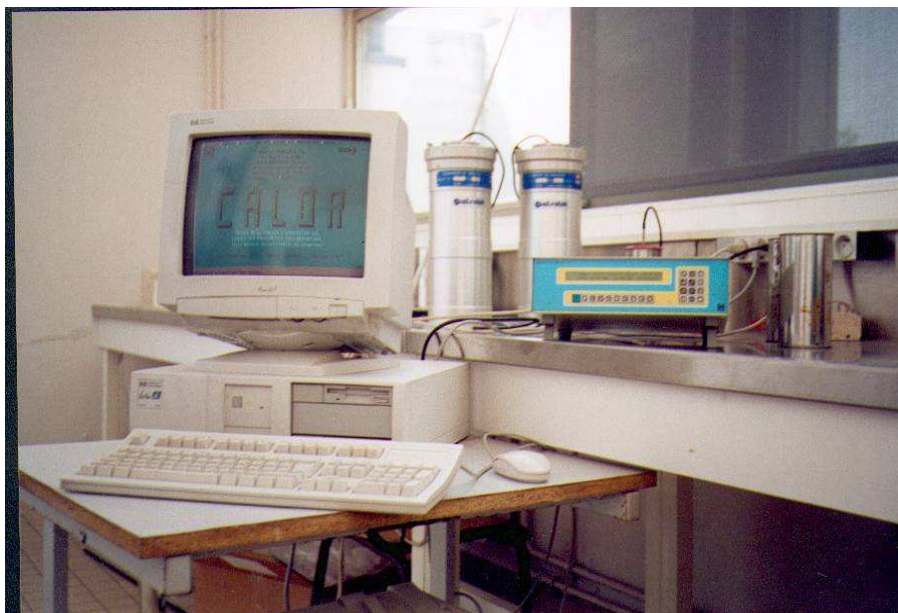
Figure 2.10: Banc d'essai pour la chaleur d'hydratation.
