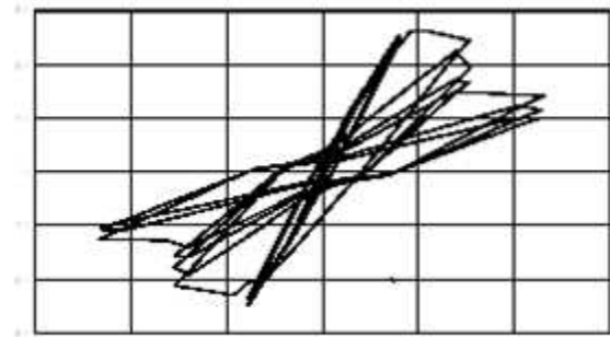
Détérioration de la résistance et Dégradation de la rigidité
