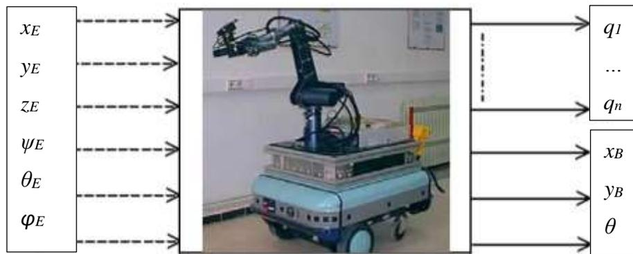
Figure 16. Calcul du Modèle Géométrique Inverse (MGI)
