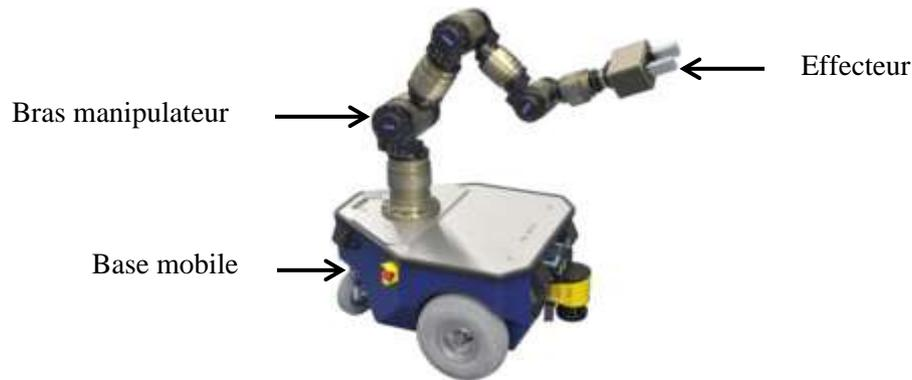
Figure 1. Manipulateur mobile "MM-500".
