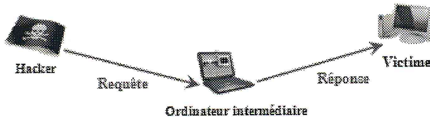
Figure 1.4 : Attaque indirecte par réponse
