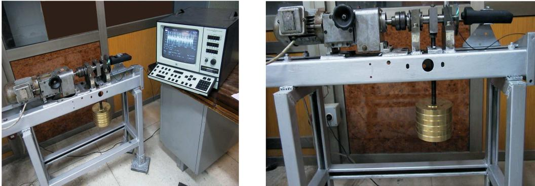
Figure II.38 Banc d'essai de simulation de défaillance de roulement [53].
