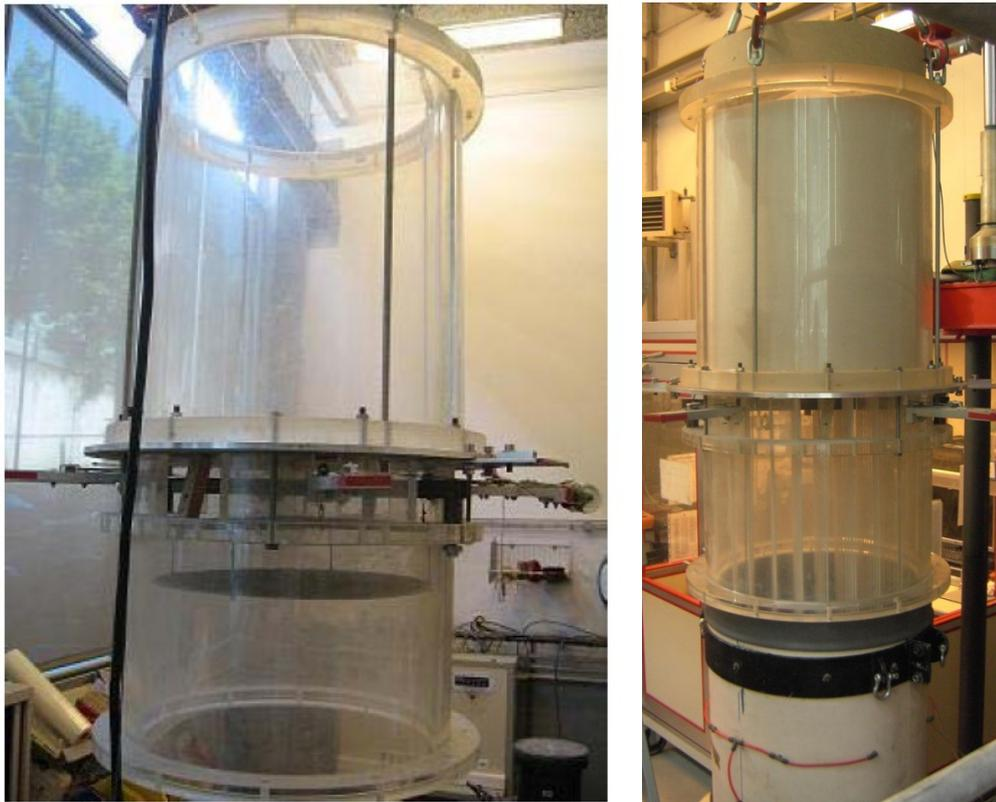
Figure 2.6 : Photos du dispositif de pluviation (d'après BEKKI H.)
