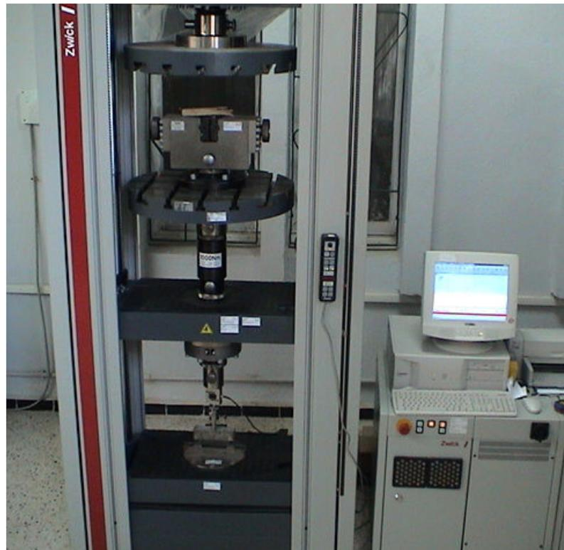
Figure 3.17: Presse de flexion trois points des épreuves de mortier et béton.
