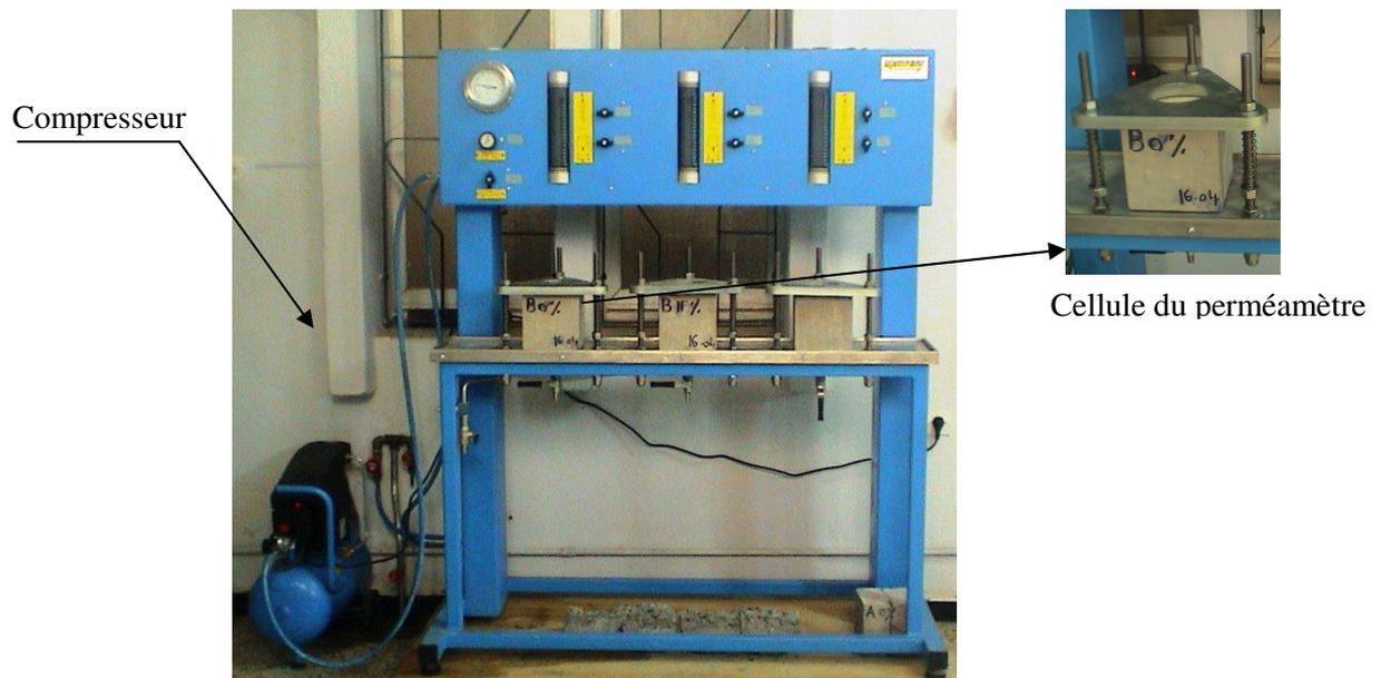
Figure 3.20: Essai de perméabilité à l'eau.
