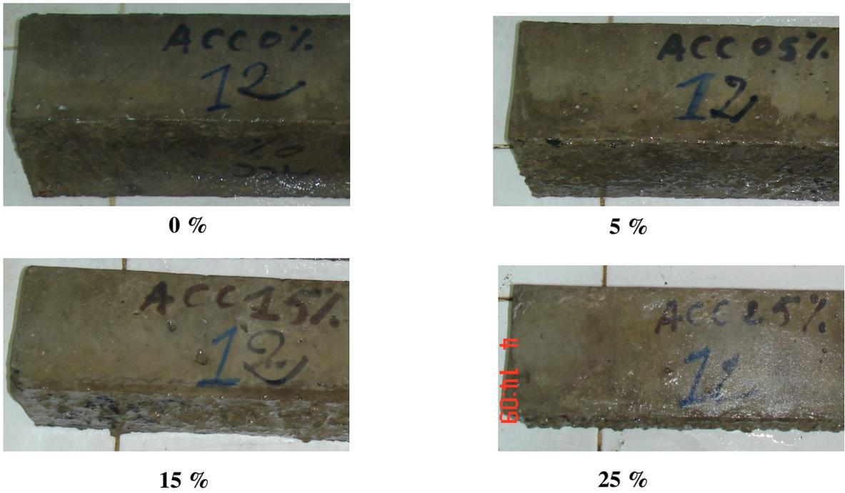
Figure 5.17: Epreuve de béton après 360 jours d'immersion dans 5% Na<sub>2</sub>SO<sub>4</sub> (Ciment D).
