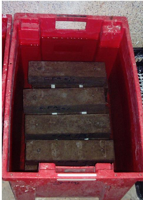
Figure 3.25: Immersion des éprouvettes dans la solution de sulfate de magnésium ( $5\%MgSO_4$ ).
