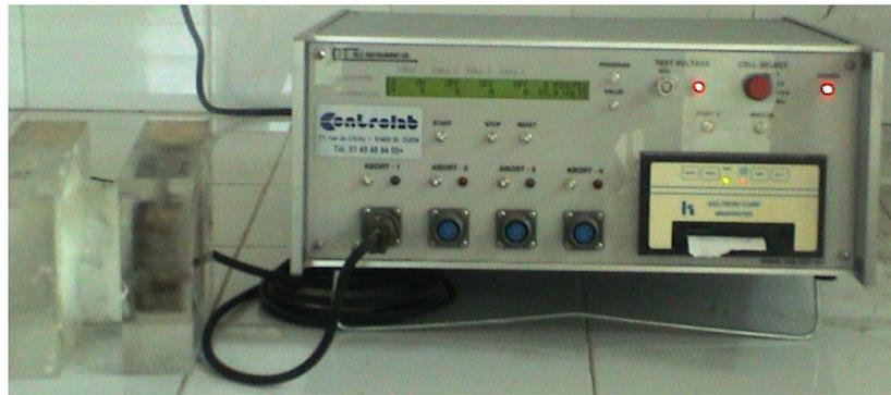
Figure 3.22: Dispositif d'essai aux ions chlorés.
