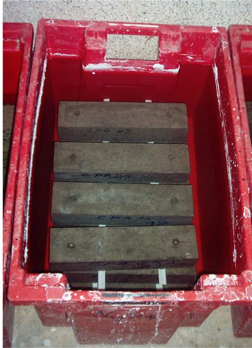
Figure 3.26: Immersion des éprouvettes dans la solution de sulfate de sodium ( $5\%Na_2SO_4$ ).
