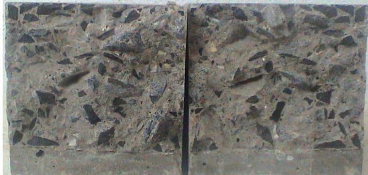
Figure 6.14: Vue typique de la surface de rupture de l'éprouvette de béton entaillée
