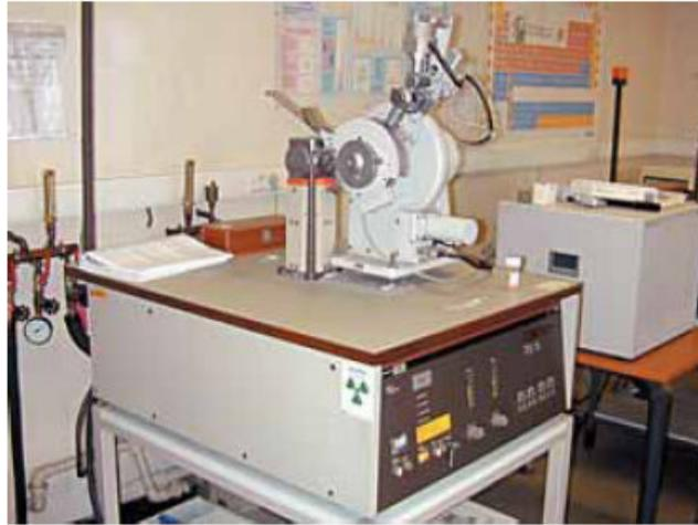
Figure 3.11: Vue d'ensemble du diffractomètre à rayons X.
