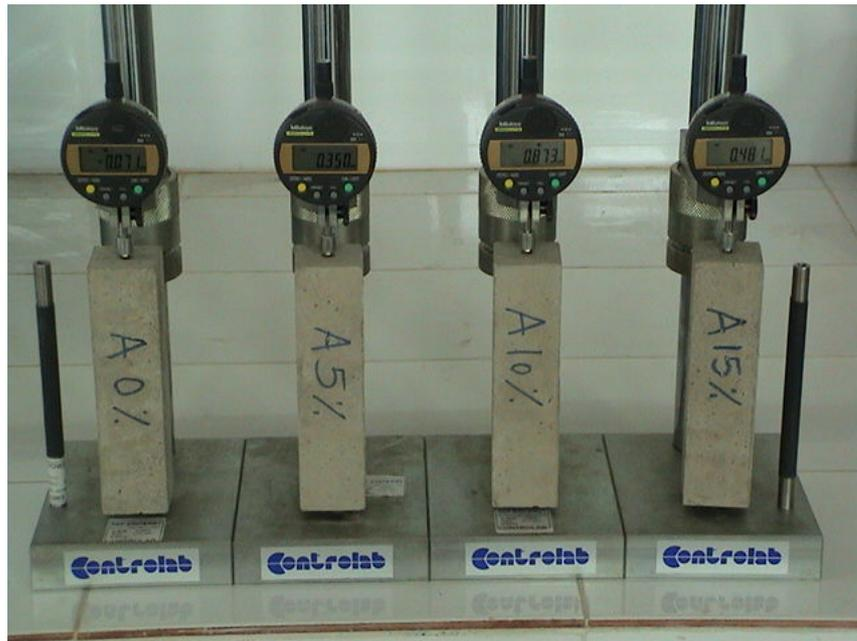
Figure 3.15: Appareil de mesure du retrait (rétractomètre).
