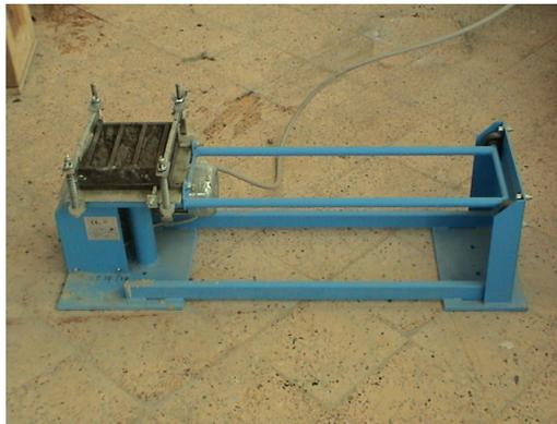
Figure 3.8: Table vibrante pour mortier.
