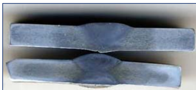
Figure V.14 : Macrographie des coupes transversales des échantillons d'aluminium 2017-T4 avant et après réparation (mono et double passes) d'épaisseur 5mm.
