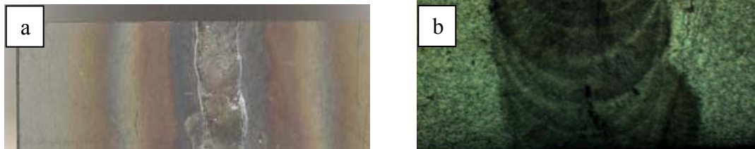
Figure V.16a,b : Macrographie de l'échantillon de la tôle d'acier inoxydable ; a/ cordon avant polissage ; b/ cordon après préparation (12X)
