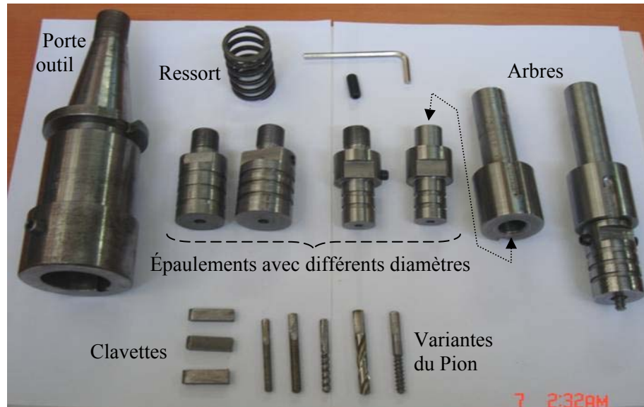
Figure VI.3 : Différents éléments réalisés de l'outil FSW
