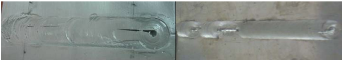
Figure E.1 : Quelques défauts dus à une instabilité dans l'effort appliqué.
