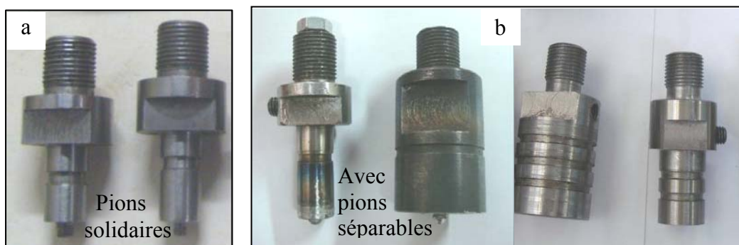
Figure VI.4 a,b : Épaulements de l'outil FSW avec : a/ Pions solidaires (lisse et fileté) ; b/ Pions séparables (ajustables par vis).
