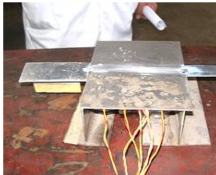
Figure III.9 : Montage expérimental de tôles pointées avant le soudage.
