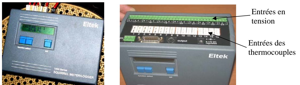
Figure B.2 a,b : Enregistreur thermique, a :Vue de face, b : Les collecteurs de données
