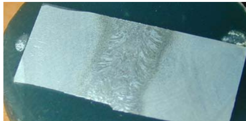
Figure V.15 : Macrographie de l'échantillon de la tôle d'alliage d'aluminium 2024-T3.
