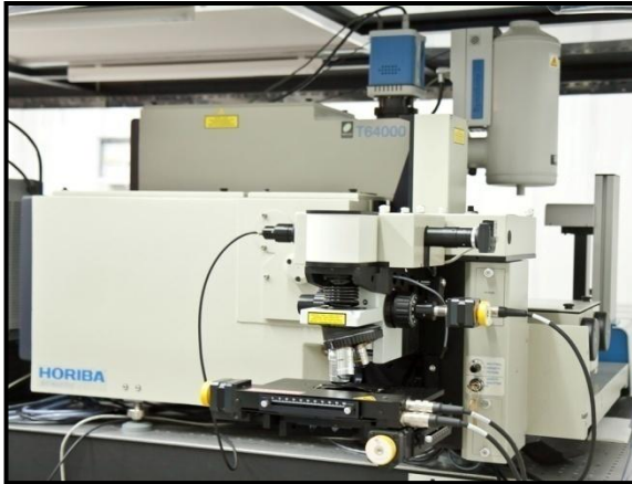
Figure 2.7 : Spectromètre JOBIN YVON HORIBA T64000.
