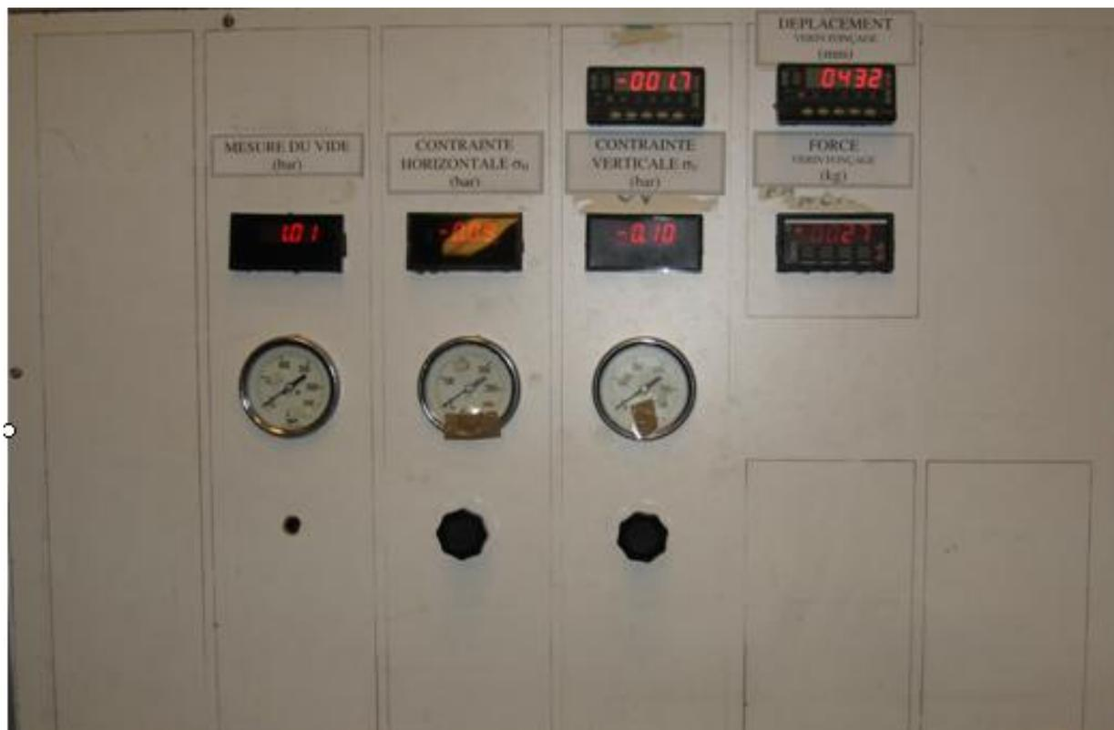
Figure 2.18 : Tableau de commande des pressions de confinement et afficheurs des différents capteurs (déplacement du vérin de fonçage, force de fonçage, pression verticale et horizontale appliquées, pression de vide)
