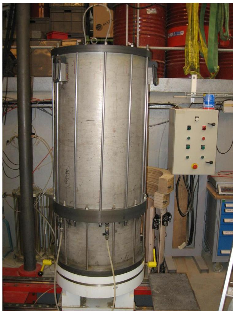
Figure 2.15 : Mise en place du couvercle, puis serrage de l'ensemble en utilisant les tiges de fixation
