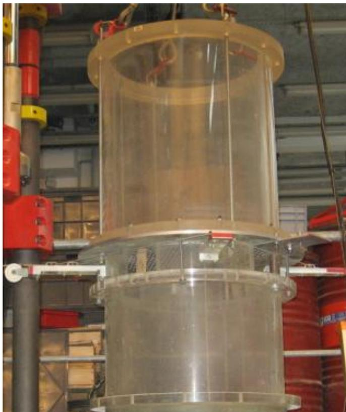
Figure 2.10 : Dispositif de pluviation du sable
