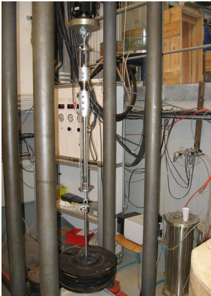
Figure 3.13 : Étalonnage du frottement positif.
