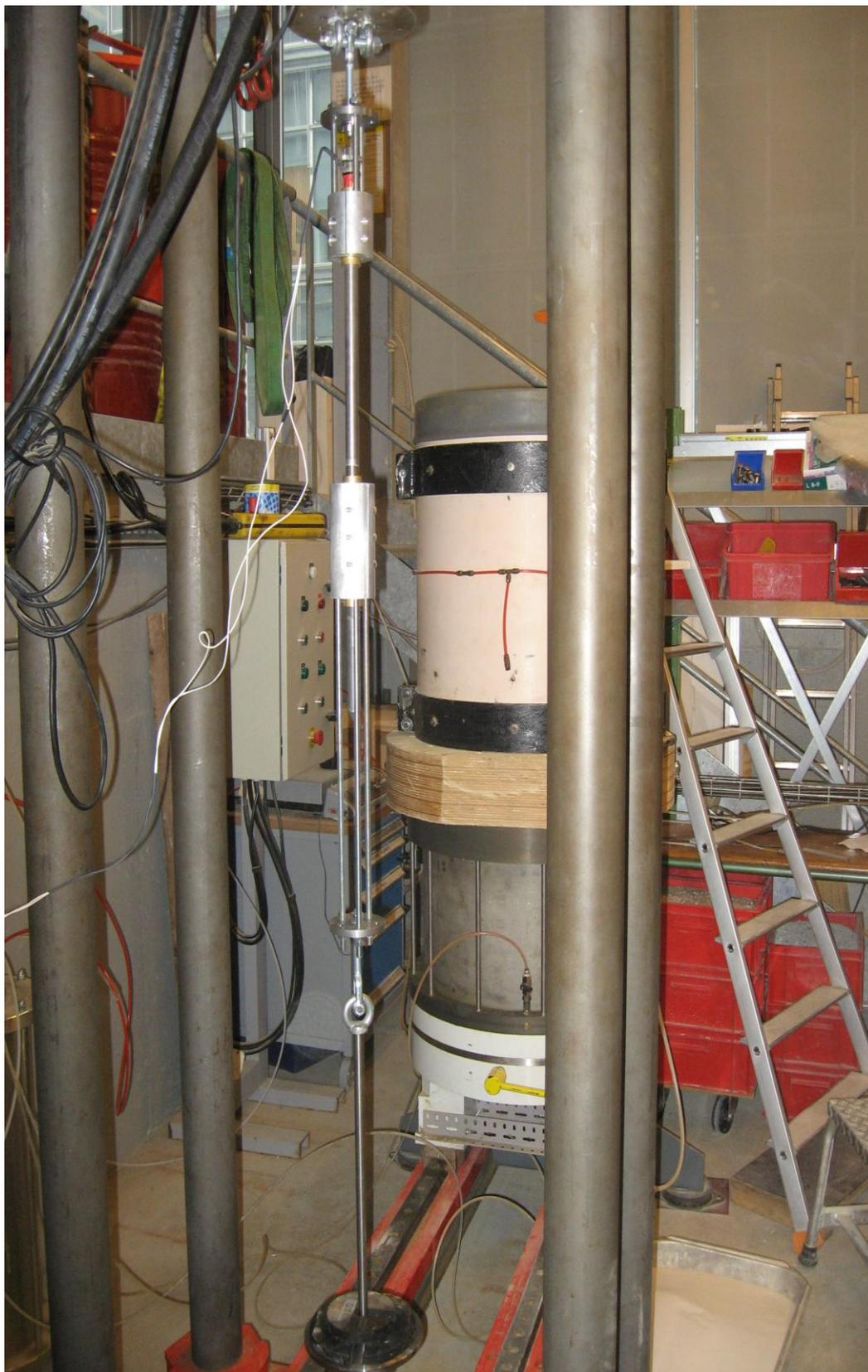
Figure 3.11 : Étalonnage du frottement négatif.
