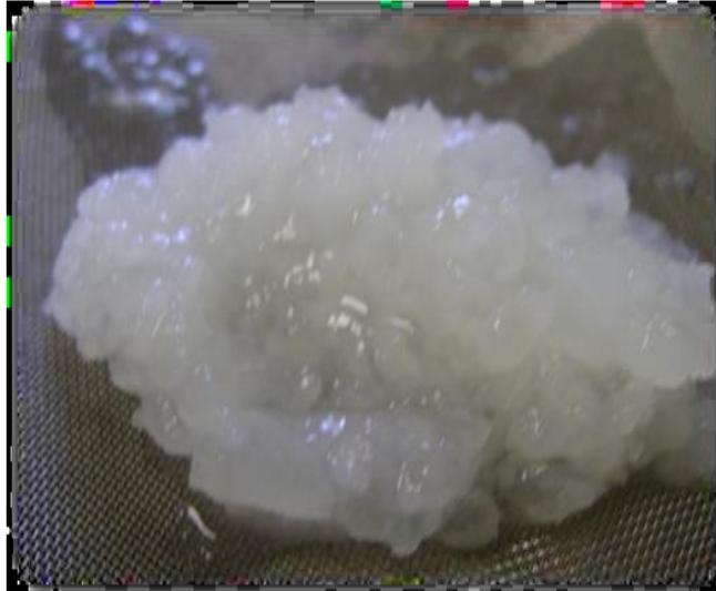
**Figure 3.12** : Photo du gel formé à base d'alginate de sodium et de chitosane à 37°C dans un milieu gastrique au pH 1.2.
