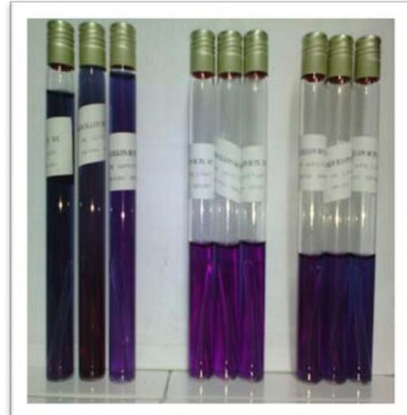
**Figure n°23.** Résultat de recherche des Coliformes dans l'eau de procès. (Originale 2017)
