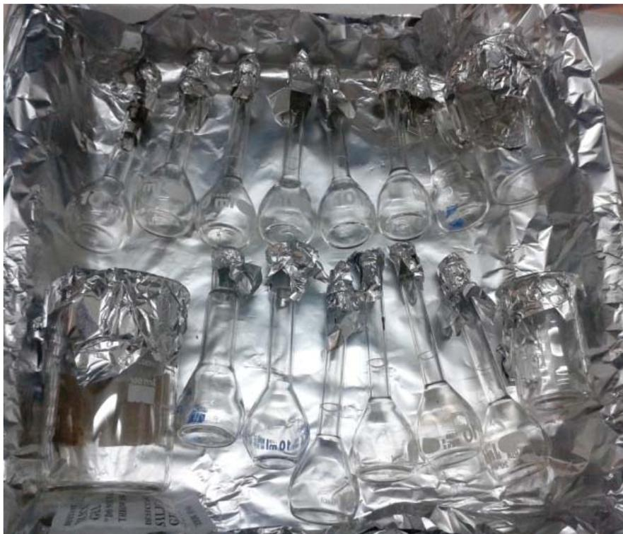
Figure 5.7: Verrerie chauffée à 400°C et obturée à l'aluminium
