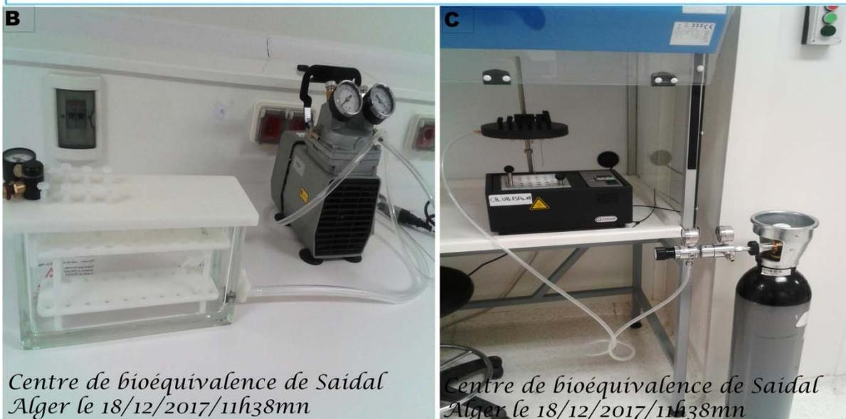
Figure 4.2: Processus d'extraction SPE, A: Etapes de l'extraction [177]; B et C: Dispositifs à vide et dispositif d'évaporation sous flux d'azote, respectivement, de centre de bioéquivalence de Saidal, Alger.
