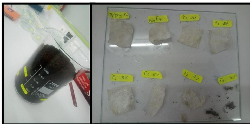
**Figure III.10** : photographie des films TPS et TPS-P pendant le test de biodégradabilité.
