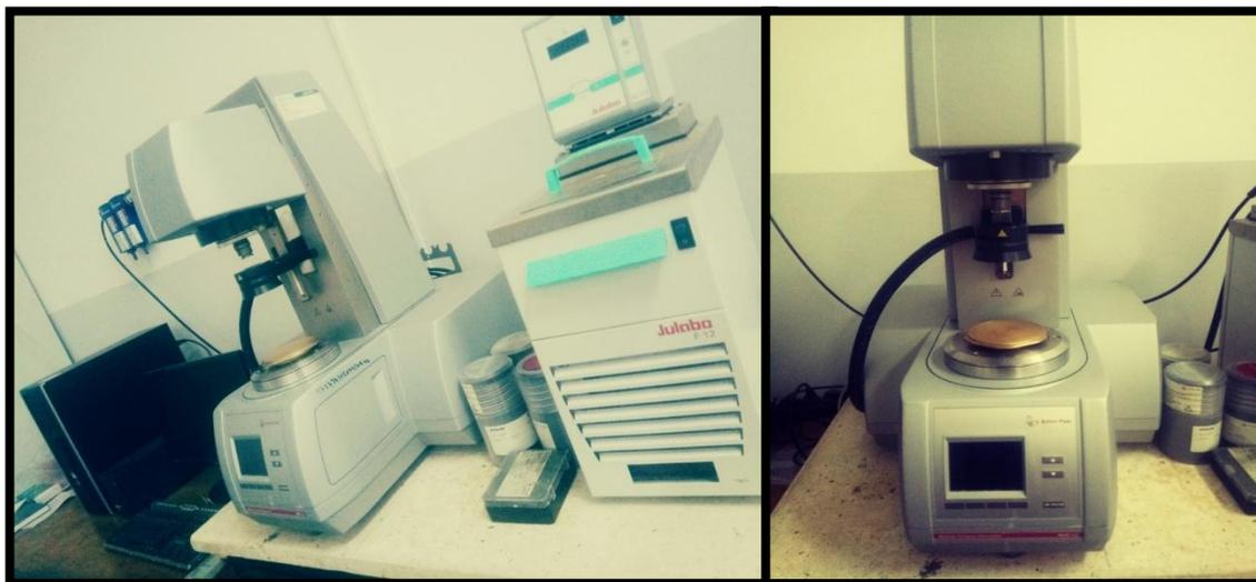
**Figure II.5 :** Rhéomètre MCR 302 Anton Paar Physica.
