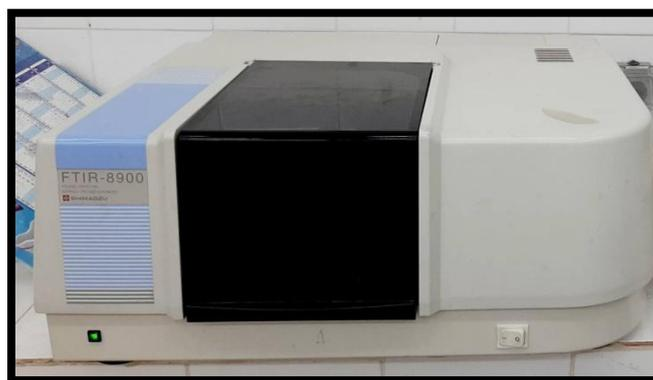
**Figure II.6 :** spectrophotomètre infrarouge à transformé de Fourier (FTIR).
