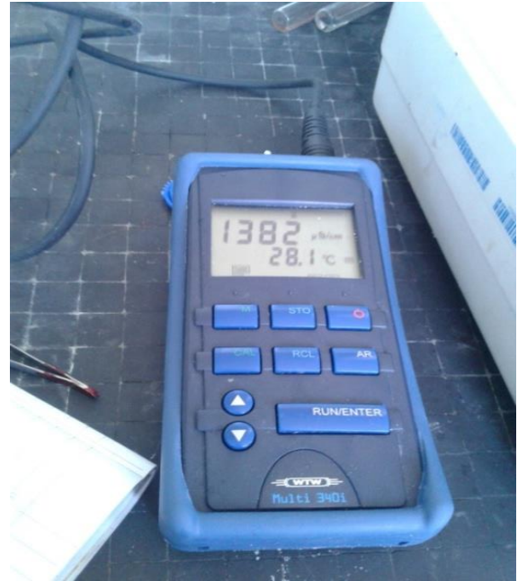
Multi-paramètre de marque WTW Multi 3401 Utilisé pour la mesure de : La conductivité Salinité O 2 dissous Température
