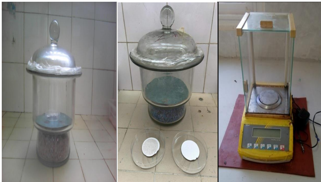
Photos numériques montrant le dessiccateur et la balance utilisé pour la mesure des MES au laboratoire de CNRDPA.
