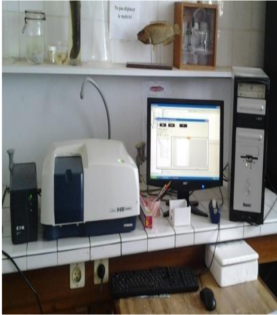
Spectrophotométrie UV-visible de marque JISCO série V.630
