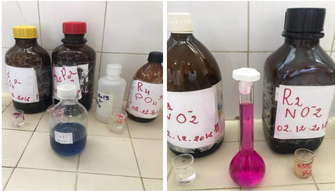
Photo numériques montrant le dosage colorimétrique de l'analyse des phosphates (bleu) et les nitrites (violet)
