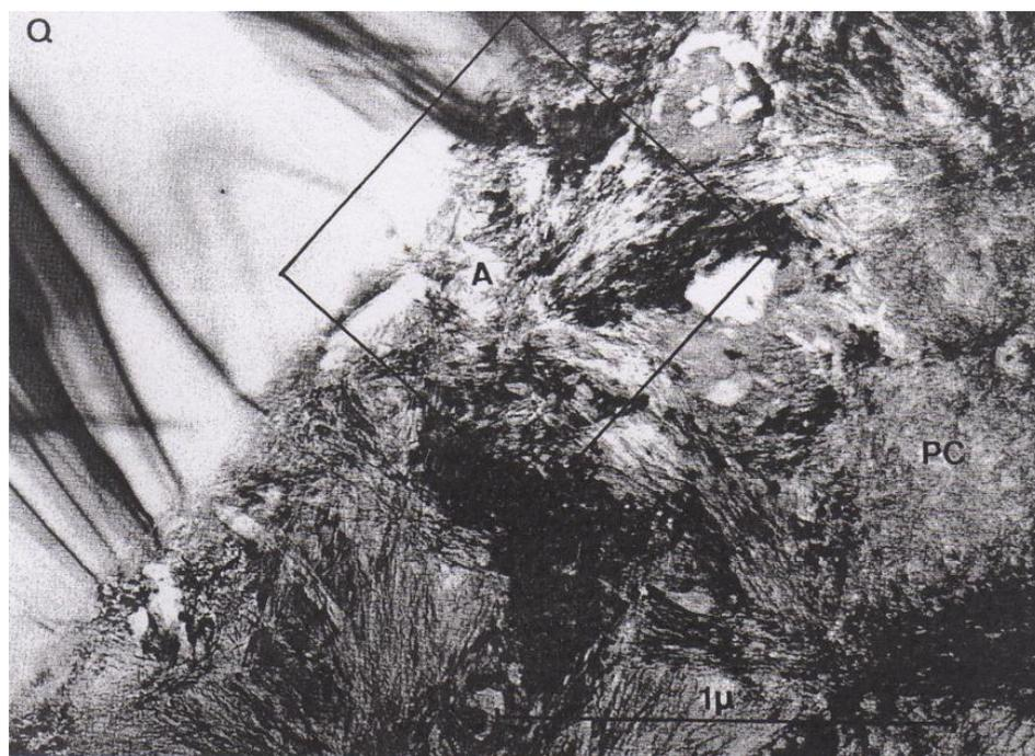
Figure 1-13 Contacte entre le quartz (Q) et la pâte de ciment (P. C) [25]
