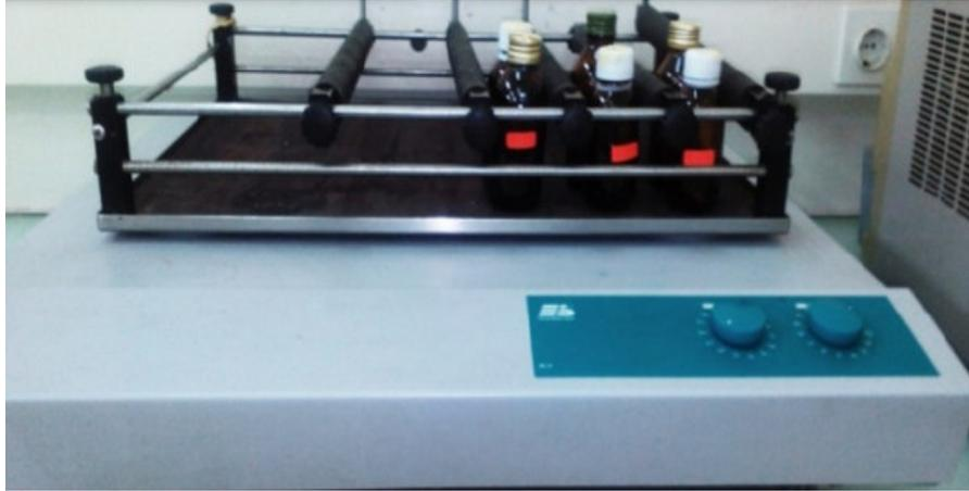
**Figure III-12** : Photo de secouer utilisé pour l'agitation.
