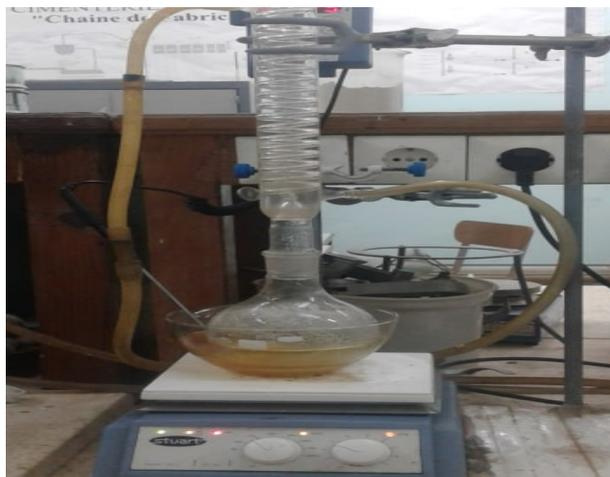
**Figure III- 5** : Préparation du silicate de sodium.
