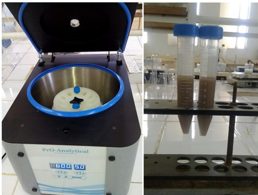
**Figure III-6** : Photo de centrifugation de silicate de sodium.
