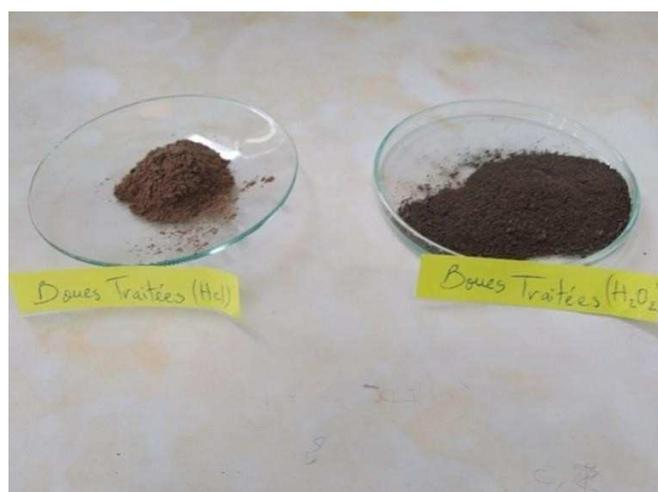
**Figure III.11:** Les boues brutes traitées par HCl et H<sub>2</sub>O<sub>2</sub>.
