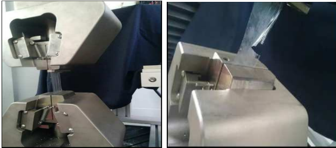
Figure II.9: application de deux forces opposées sur un échantillon d'un film Jusqu'à la rupture de ce dernier.
