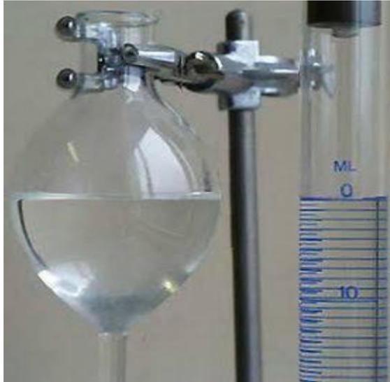
**Figure. II.9. Vérification du niveau de la solution saturée en NaCl avant le commencement du contrôle**
