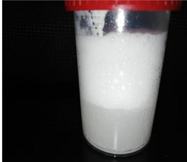
**Figure III.28 Résultat de test d'effervescence pour le produit formulé avec le mélange de deux lécithine**
