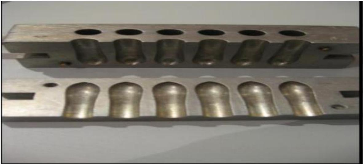
**Figure.I.10. Moule à suppositoires par compression.[25]**
