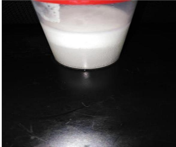
**Figure III. 26. Résultat de test d'effervescence de produit formulé avec la lécithine ayant un HLB élevé**
