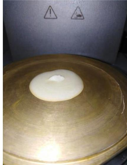
**Figure II.13. Échantillon d'un suppositoire effervescent sur le rhéomètre MCR 302 dans son état liquide**
