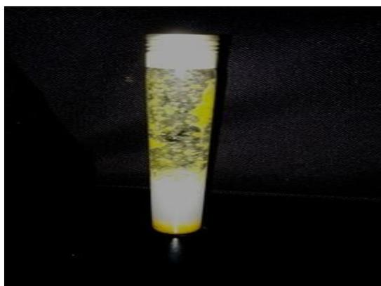
**Figure II.5. Test de dispersibilité de lécithine de soja de BIMO dans l'eau**
