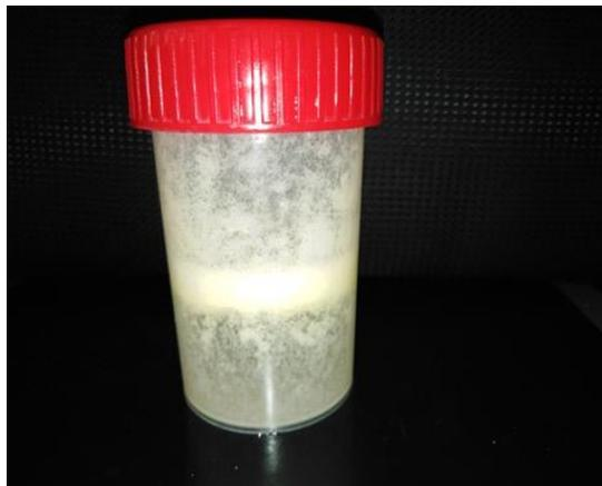
**Figure. III. 27 Résultat de test d'effervescence pour le produit formulé avec la lécithine ayant un HLB bas**
