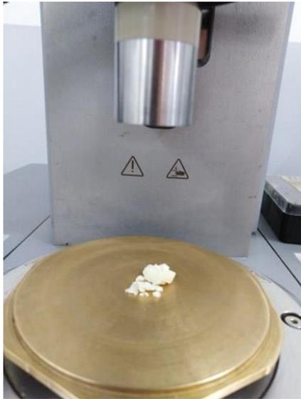
**Figure II.12. Échantillon d'un suppositoire effervescent sur le rhéomètre MCR 302 dans son état solide**
