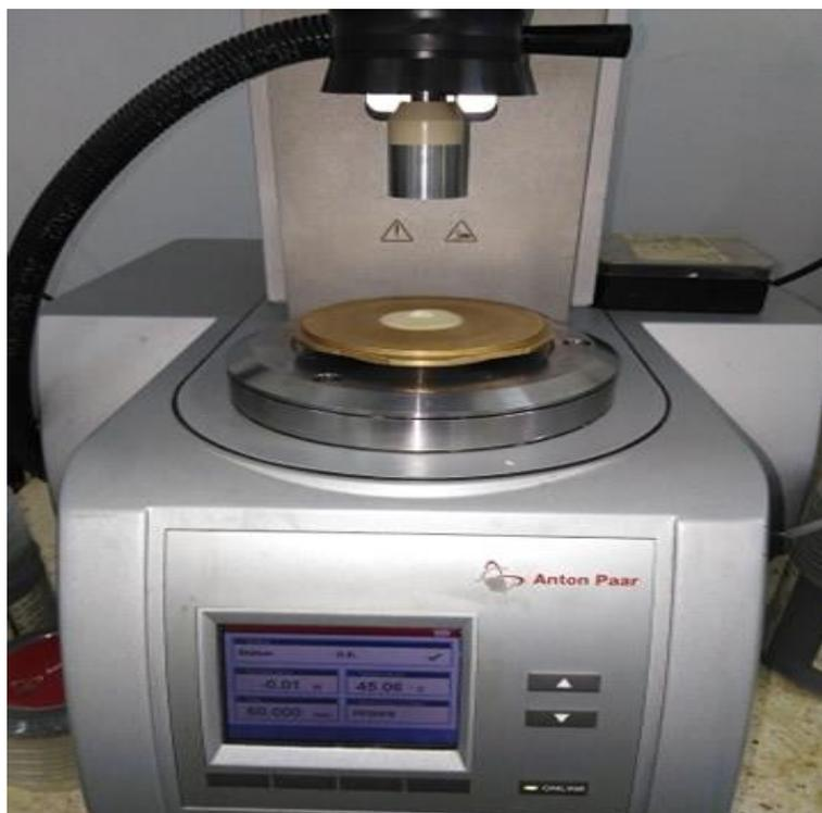
**FigureII.11. Image représentant le rhéomètre MCR 302**
