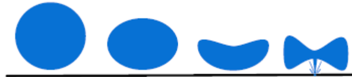
Figure 1.6 : Évolution d'une bulle de cavitation à proximité d'une surface solide.
