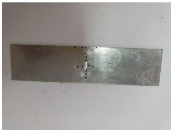
Figure 4.2: Plaque d'Al 7075 avec un défaut elliptique centré
