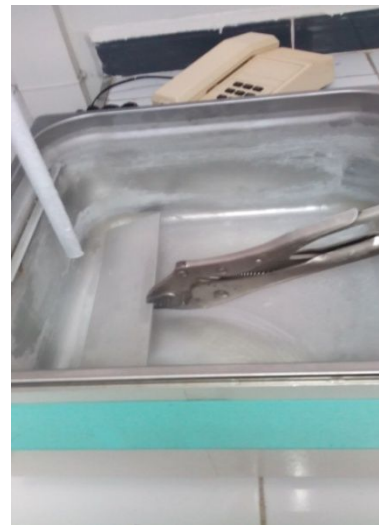
b: Immersion des tôles d'Aluminium dans l'Azote liquide
