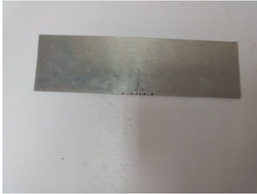
Figure 4.1: Plaque d'Al 7075 avec une rainure
