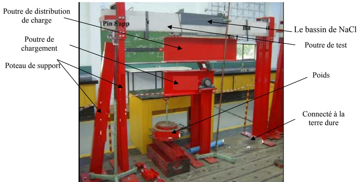
Figure I-19 Le Système de chargement utilisé par Malumbela et al [86, 90]
