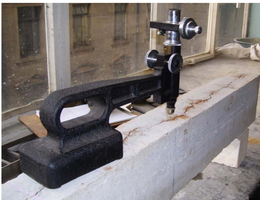
Figure II-25 Mesure des ouvertures des fissures.
