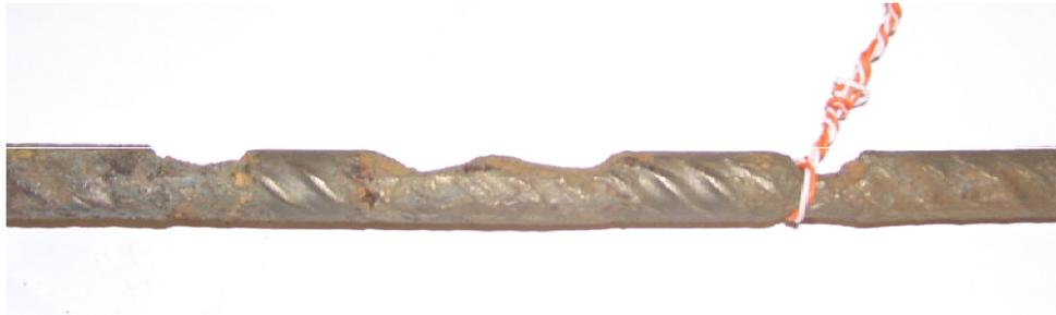
Figure III. 2: Etat des barres d'acier corrodées.
