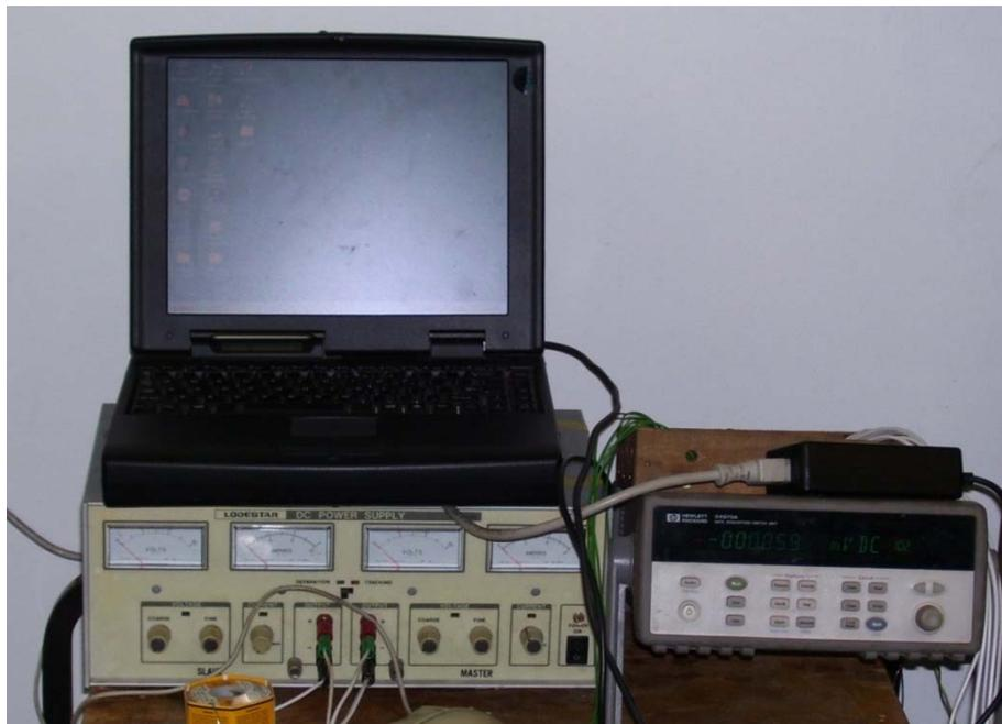
Figure II-19 : Générateur du courant électrique et central d'acquisition.
