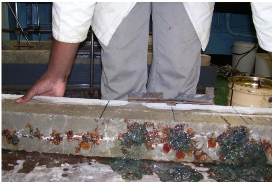
Figure II-24 : Rouille provoqué par la corrosion des armatures.
