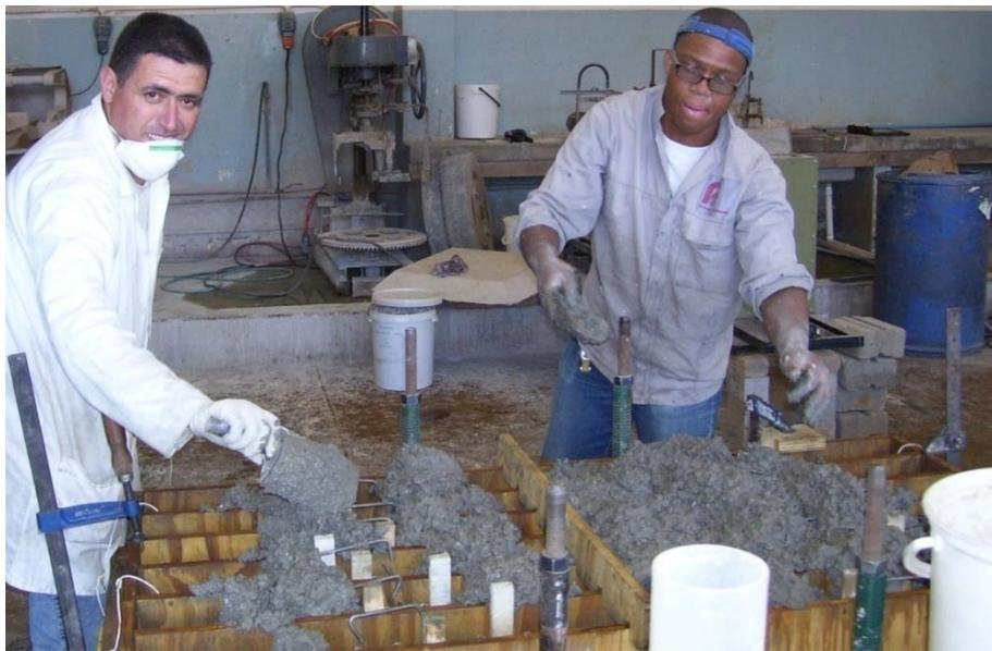
Figure II.16 : Mise en œuvre du béton.
