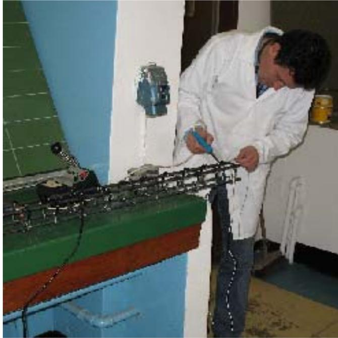
Figure II-13 Soudage du fil électrique à la barre pour l'accélération de corrosion.
