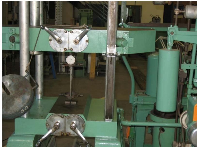
Figure II-2 Essai de traction des barres d'acier.
