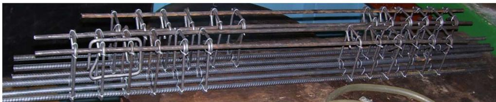
Figure II.15 : Ferrailage des poutres de contrôle (non corrodée).
