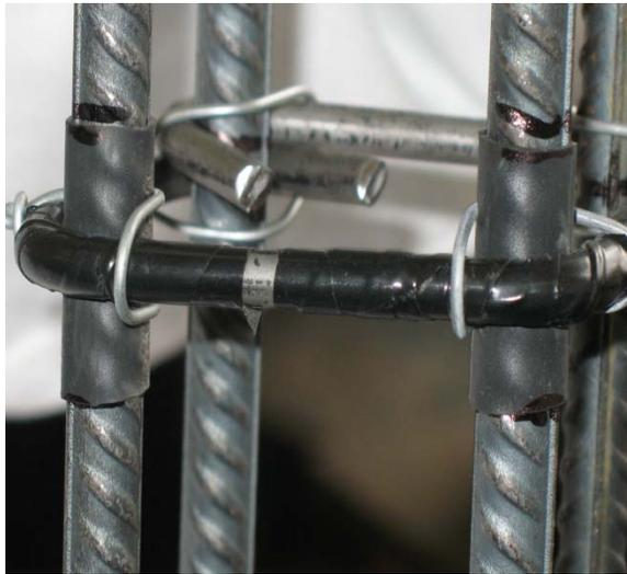
Figure II-12 Dispositifs de protection des cadres contre la corrosion.
