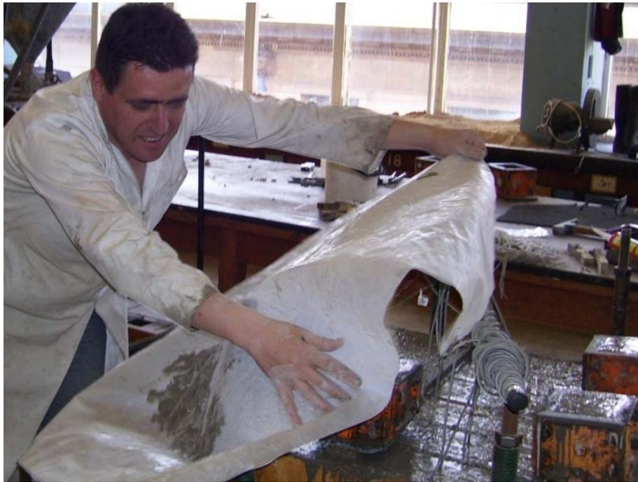
Figure II-17 Couverture des poutres et les éprouvettes par le plastique.
