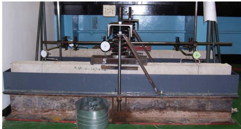
Figure II.21 : Dispositif expérimental.
