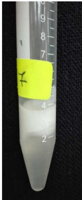
**Figure (III.4) :** Photo présentant une séparation de phases, à 45°C, suite au test de la mise en étuve.
