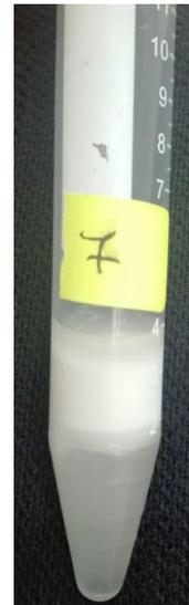
**Figure (III.3) :** Photo illustrant une séparation de phases à T ambiante, suite au test de centrifugation.
