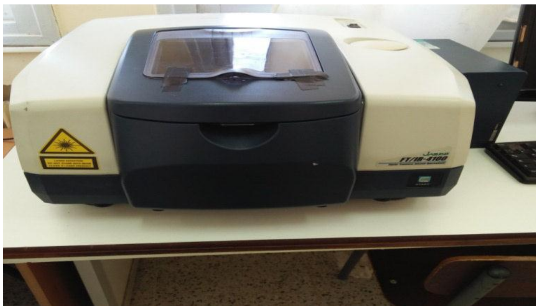
Figure II.2 : Appareil FT-IR utilisé.
