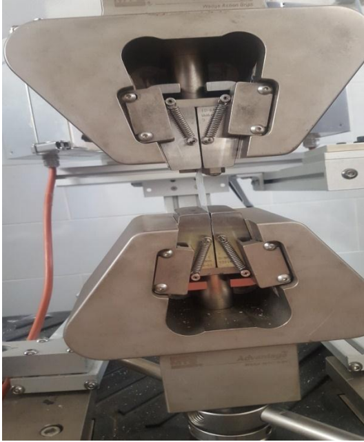
Figure II.3 : Machine de test de traction (ZWICK, modèle Roell Z0).
