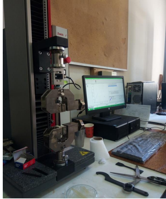
Figure II.3 : Machine de test de traction (ZWICK, modèle Roell Z0).
