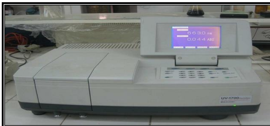
Figure 2.4 : Photo représentatif d'un spectrophotomètre UV-Visible de type SHIMADZU-1700.
