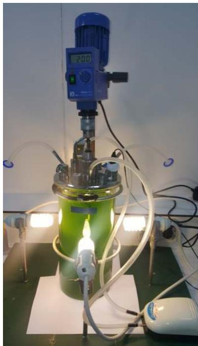
Figure III. 3 : Installation expérimentale utilisée pour la culture des microalgues
