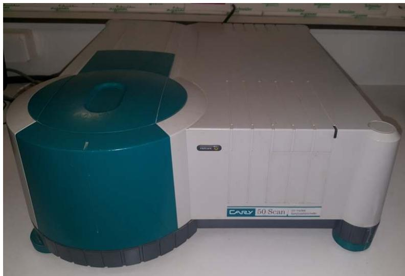
**Figure III. 5 : Spectrophotomètre utilisé pour le suivi de la croissance algale**
