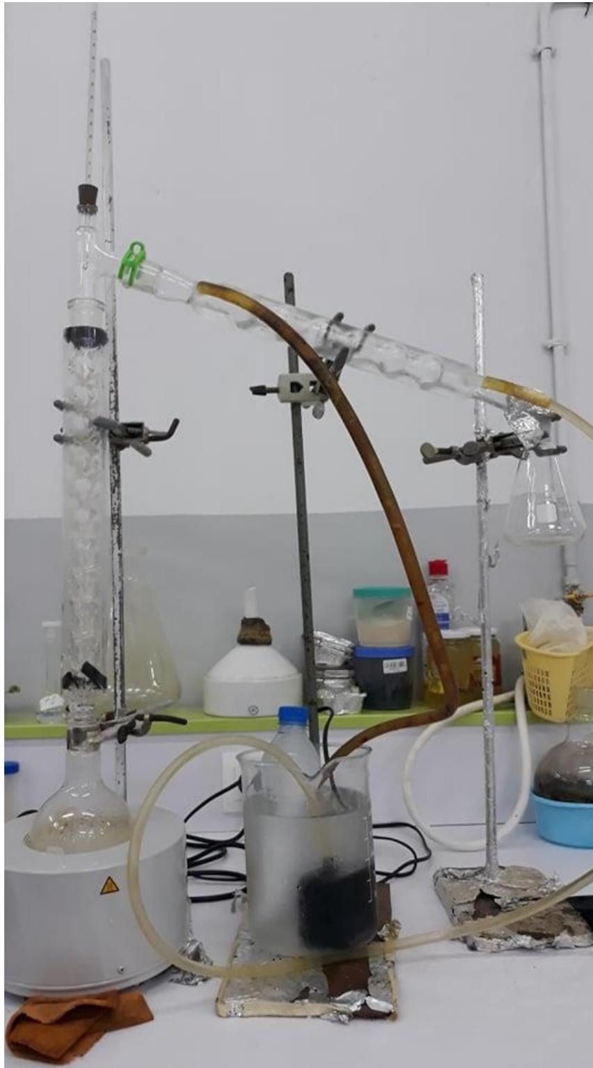
Figure : Distillation du bioéthanol
