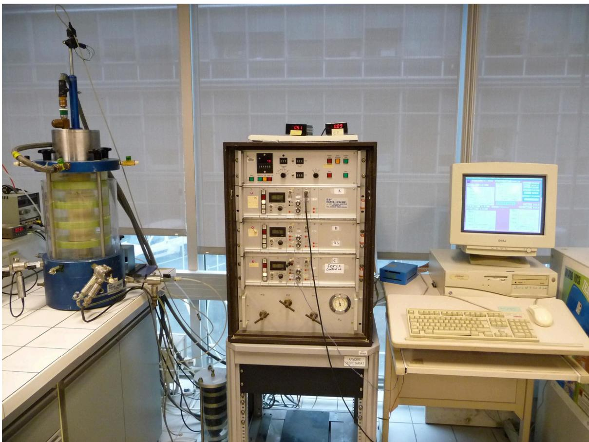
*Figure 102 : Vue du dispositif triaxial asservi type Buehl et Faubel
