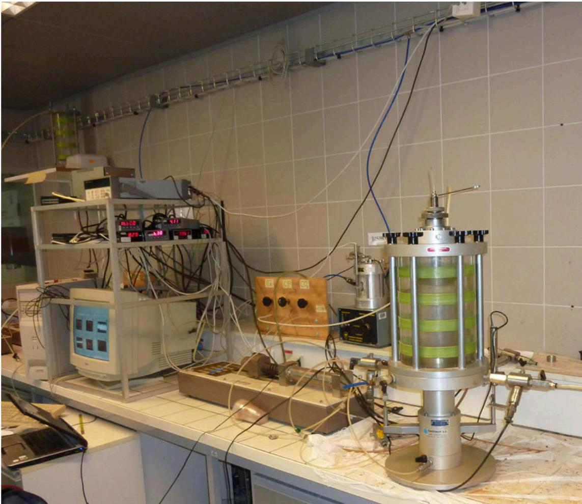
*Figure 99 : Vue globale de l'appareil triaxial de type Bishop et Wesley (Navier - CERMES, Ecole des Ponts ParisTech, France).*
