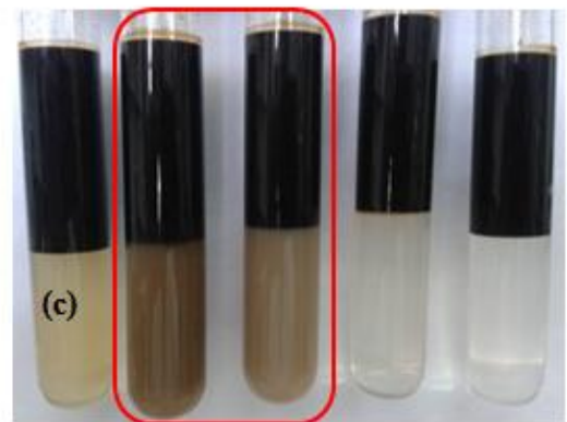
Figure IV.13. Comportement de phase du système \text{Na}_2\text{CO}_3/\text{C}_{17}\text{EO}_{13} (0,05% masse)/huile/saumure par balayage de la concentration de \text{Na}_2\text{CO}_3 pour différentes fractions volumiques de brut : 10% (a). 30% (b) et 50% (c), T = 51\text{ }^\circ\text{C} . X : pourcentage massique de \text{Na}_2\text{CO}_3 .
