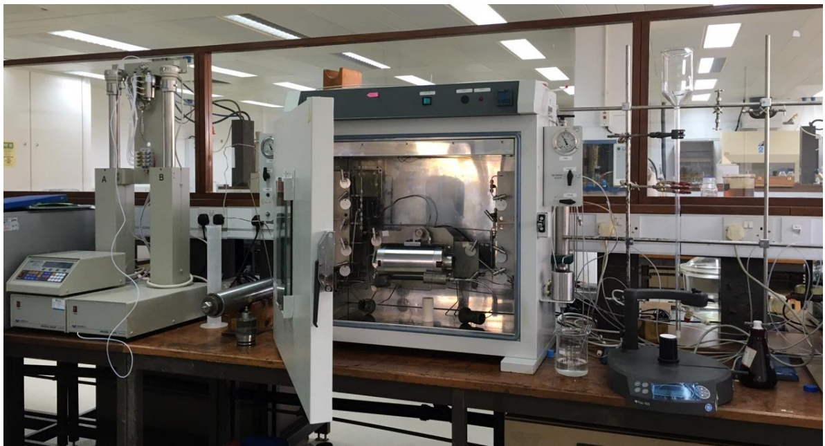
Figure III.7. Dispositif (Core Flood) utilisé pour les tests de déplacement de l'huile résiduelle
