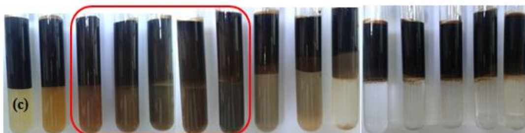
Figure IV.17. Comportement de phase du système Na 2 CO 3 /C 17 EO 13 (0,3%)/huile /saumure par balayage de la concentration de Na 2 CO 3 pour différentes fractions volumiques d'huile : 10% (a), 30% (b) et 50% (c), Temp = 51 °C. X : pourcentage massique de Na 2 CO 3 .
