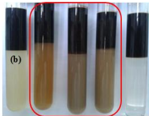
Figure IV.13. Comportement de phase du système \text{Na}_2\text{CO}_3/\text{C}_{17}\text{EO}_{13} (0,05% masse)/huile/saumure par balayage de la concentration de \text{Na}_2\text{CO}_3 pour différentes fractions volumiques de brut : 10% (a). 30% (b) et 50% (c), T = 51\text{ }^\circ\text{C} . X : pourcentage massique de \text{Na}_2\text{CO}_3 .
