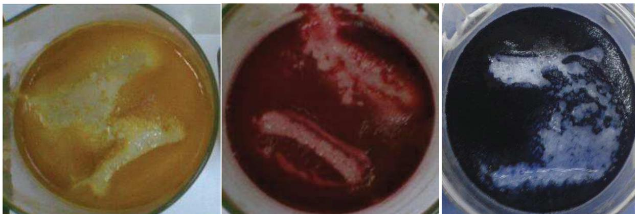
Figure 5.37 : Floccs formés flottant à la surface de la cellule EC (Fin du traitement par EC).
