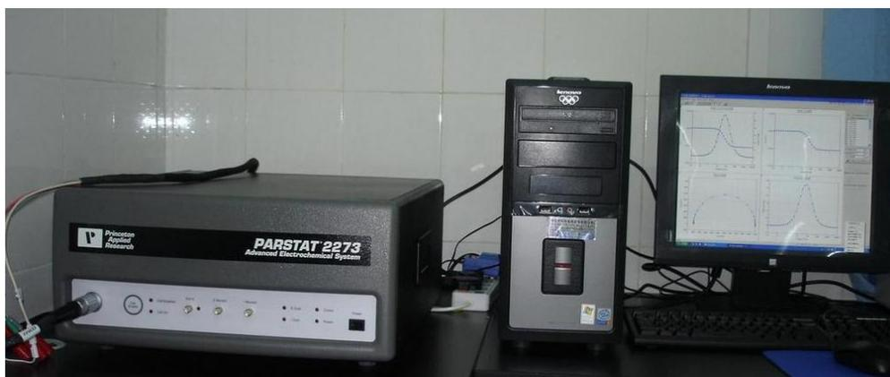
Figure 2. 7 : Potentiostat de marque EG&G modèle PARSTAT 2273.
