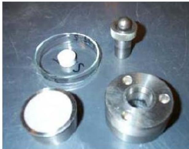
Figure 2. 3 : Les modules utilisés pour le compactage unidimensionnel de la bentonite.
