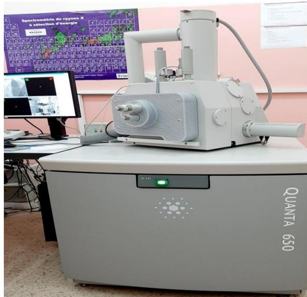
**Figure II.3 :**MEB FEI Quanta 650
