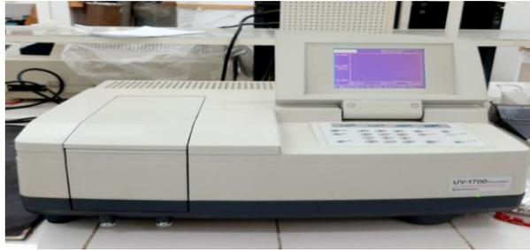
**Figure II.8 :** Un spectrophotomètre Shimadzu UV-1700 Pharmaspec .
