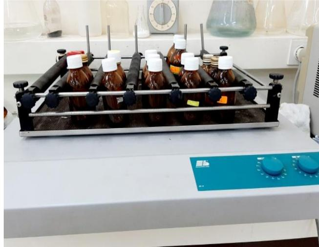
**Figure II.7 :** Un agitateur orbitalairede « Edmund Buhler GmbH SM-30 »
