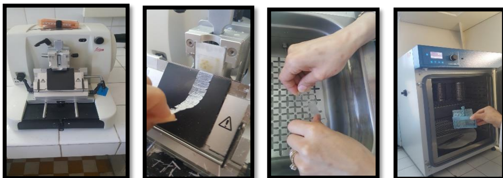
Figure III.8 : Photos numérique montrant les étapes de la microtomie.
