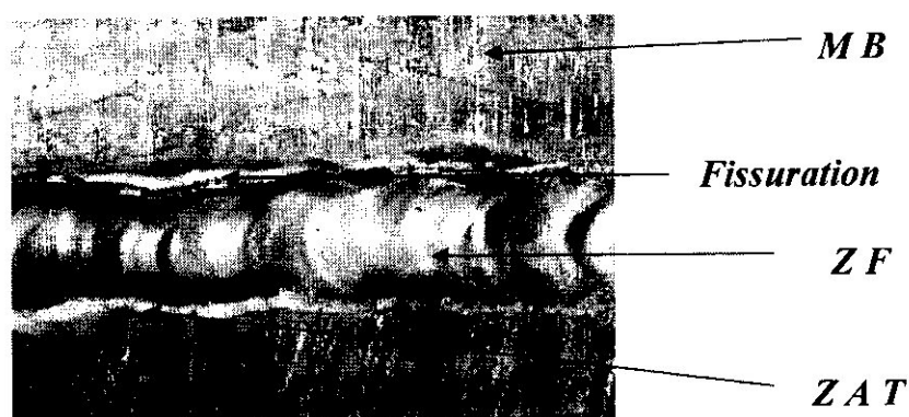
Fig (III-9-2) Représentation macrographique du cordon de soudure (A-8)
