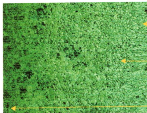
Fig (III-21) Représentation micrographique(x50) des 3 zones -échantillon A-10(2024)
