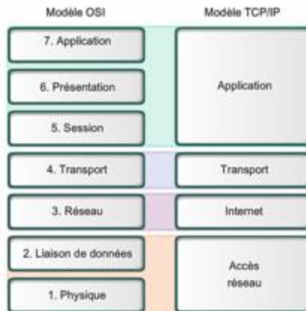
**Figure 12** : Comparaison entre modèles OSI et TCP IP [14]
