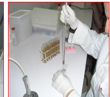
Avec lance de Henlé prendre quelques gouttes sur la lame
