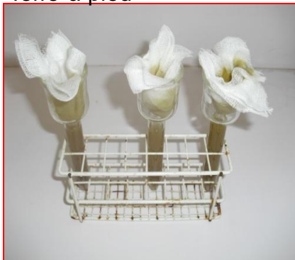
Filtrer sur plusieurs épaisseurs de Gaz de 30 microns dans un tube conique
