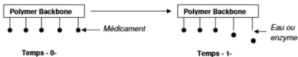
Figure 1.7 : Mécanismes de contrôle de la libération d'un principe actif par réaction chimique avec le système à chaînes polymères greffées.
