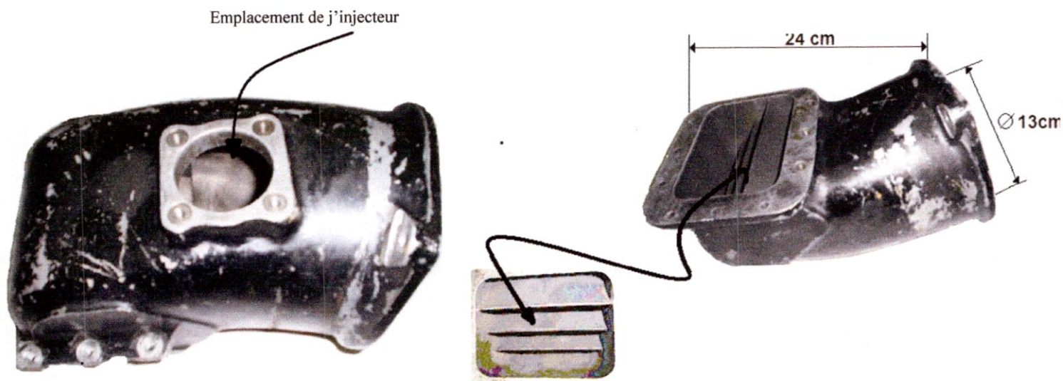
Figure (3-9) : photo du redresseur
