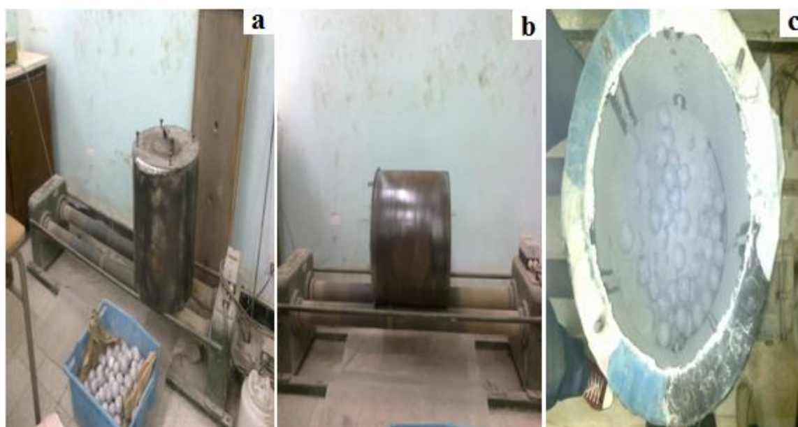
Figure 3.2 : Broyage de laitier, (a) Broyeur à boulet, (b) Broyeur en rotation, (c) Laitier après broyage.
