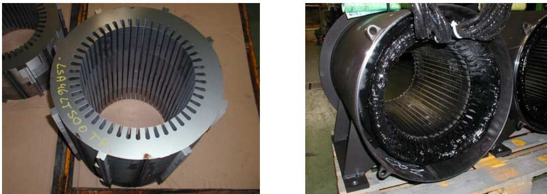
Figure 1.8 : Empilement des tôles du stator.
