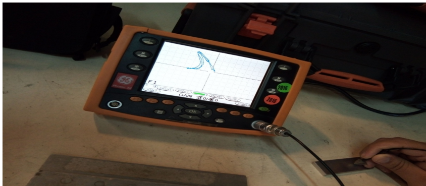
Figure IV.30 : Résultat d'une pièce fissurée.
