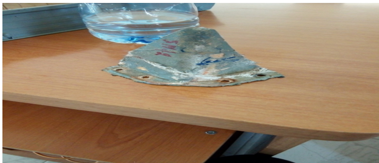
Figure III.7 : protection antenne radio endommagé.
