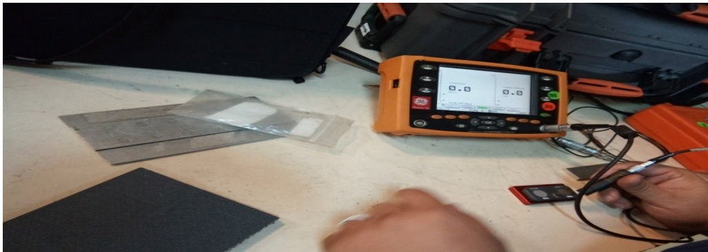
Figure III.26: appareil de courant de Foucault avec une sonde de conductivité.
